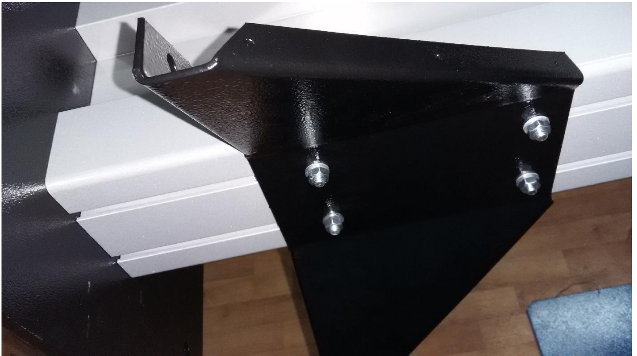
Рис. 3а. Монтаж боковых опор на стойку.
