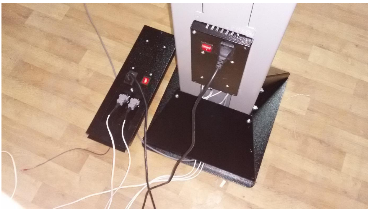
Рис. 13а. Подключение питания модулей камер.
