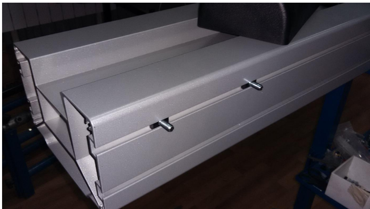
Рис. 5а. Крепления для кронштейна.
